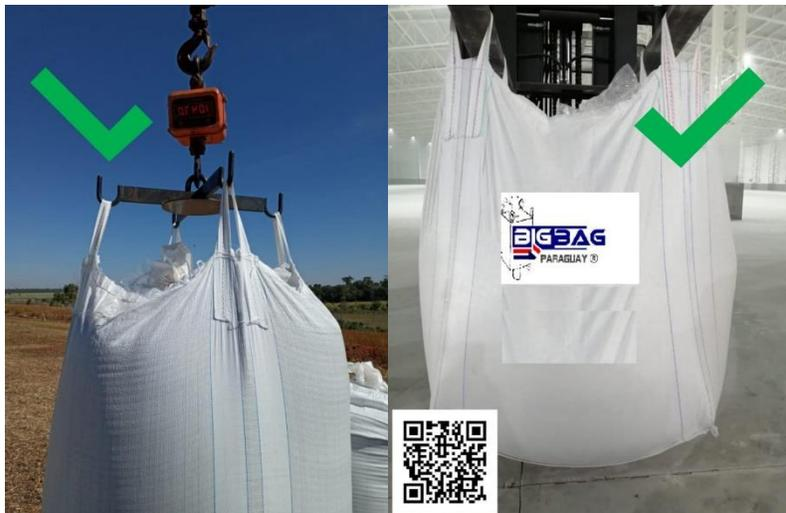
El big bag deberá estar en **posición vertical**. Sin nudos, inclinaciones ni torsiones para evitar accidentes, ni rotura del material.
